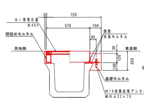
注) 車道側に基礎を設けアンカーをとる
