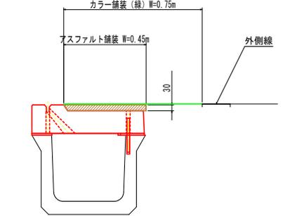
(注) 車道側に基礎を設けアンカーをとる
